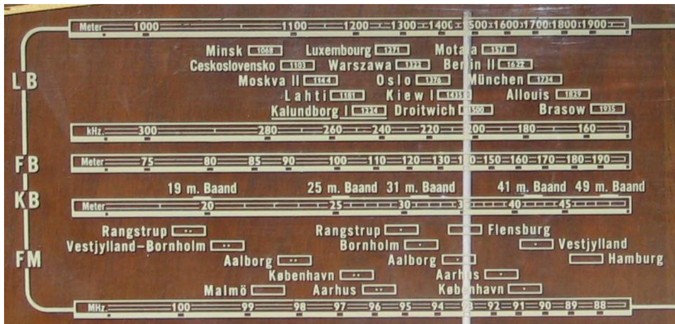
Udsnit af skalaen på en dansk Herofon radio fra 1959, hvor FM-båndet er noget mere overskueligt end i dag. Bemærk at 'fiske-bølge', FB-området 75-190 meterbåndet også er med. (Foto LKP)
