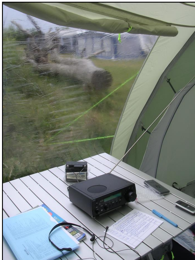
Set-up'et i Outwell-teltet med en AOR AR7030+, stavantenne og et 12 volt scooterbatteri, der leverer strøm i op til fire timer - højst. Desuden de mest nødvendige frekvenslister. Foto: BV
